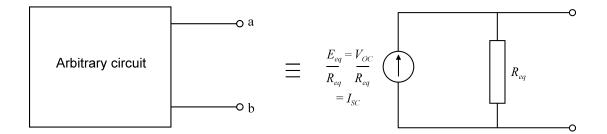
Here  $I_a = I_{eq} - R_{eq}$ .  $V_{ab}$ ,
